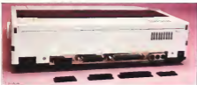
Sul lato dell'apparecchio sono disposti l'intercettore di accesso, la porta per l'altimemoria e la quarta porta di I/O. Due seriali: una per il disco esterno ed una per il registratore a cassette
